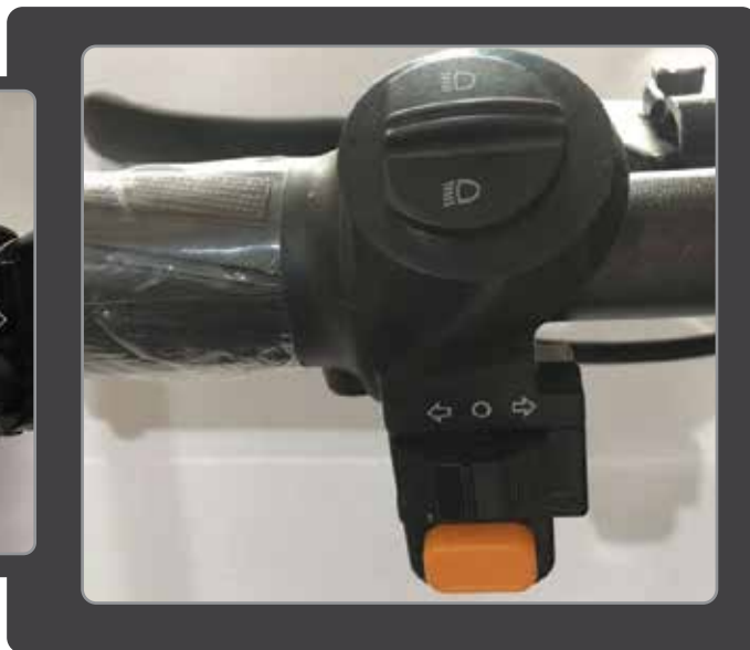
Η αριστερή λαβή: + Διακόπτης φώτων κεφαλής + Αριστερός ή δεξί διακόπτης φώτων περιστροφής + Κίτρινο κουμπί κωρνας
